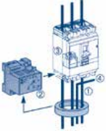
① Toroid ② Vigirex röle ③ MX bobini ④ Nötr
